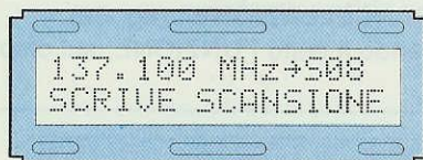
Fig.31 Per utilizzare questa nuova frequenza per la Scansione, dovrete premere i tasti +/- fino a far apparire sulla prima riga S08-S09 ecc. e poi Enter.
