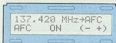
Fig.47 Per inserire e memorizzare l' AFC , premete il tasto FUNZ . fino a quando non apparirà sulla seconda riga AFC , poi il tasto + e quindi il tasto ENTER fino a far apparire SETUP OK (vedi fig.49).
