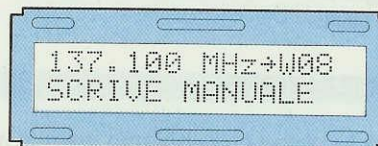
Fig.30 Per memorizzare altre frequenze premete il tasto FUNZ. fino a far apparire sul display la scritta Scrive Manuale e i tasti +/- fino a far apparire sulla prima riga W08-W09 , ecc.
