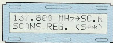
Fig.44 Per la scansione automatica delle frequenze memorizzate, premete il tasto FUNZ . fino a far apparire la scritta SCANS.REG. , poi premete il tasto ENTER .
