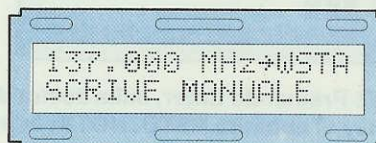
Fig.32 La scritta Scrive Manuale WSTA serve per memorizzare la frequenza di partenza della Scansione in Frequenza.
