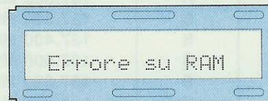
Fig.27 Questa scritta apparirà se avrete inserito male la Eprom IC5 o non avrete saldato bene tutti i suoi piedini.
